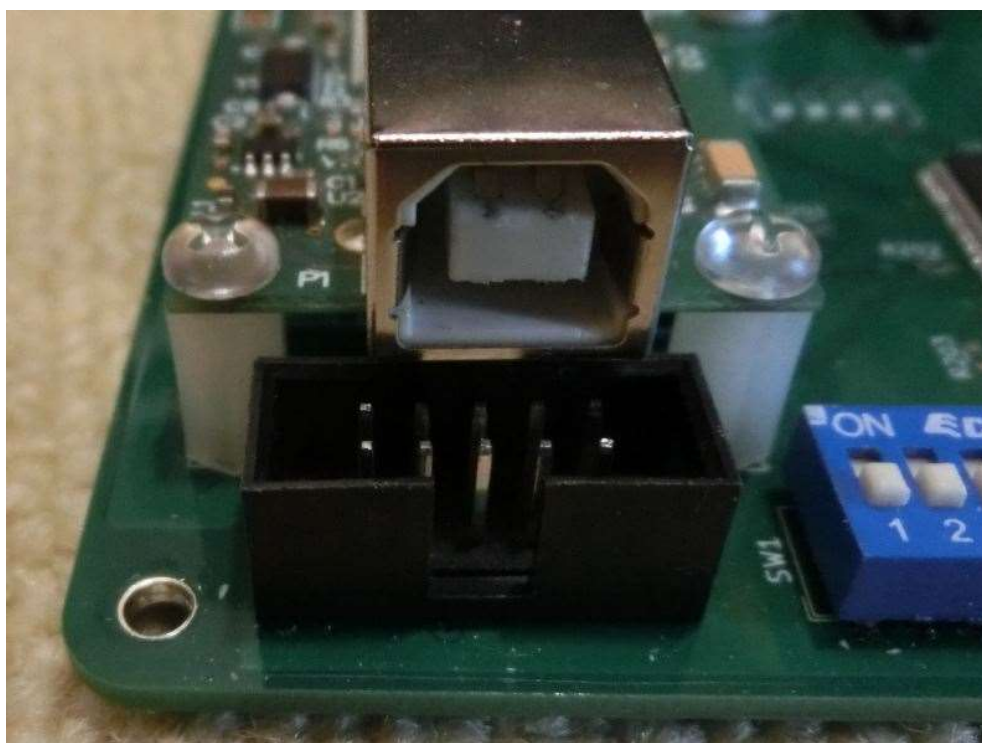
写真 5. Amanero COMBO384 をプラスチックネジで固定する
