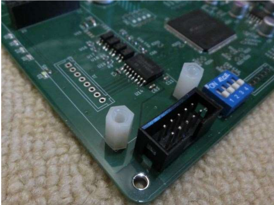
写真3. プラスチックスペーサ取り付け
