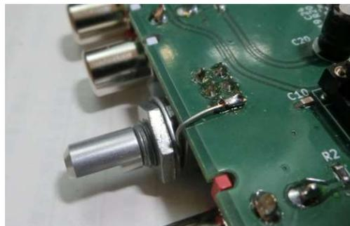
写真 1, 2. VR フレームを GND に接続する
